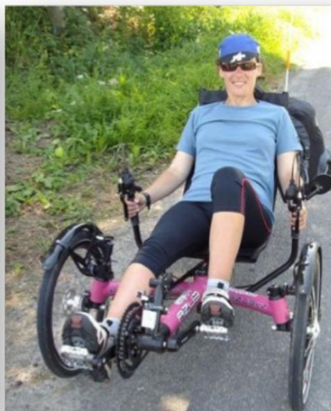
C'est un tricycle avec les deux roues avant directrices et une roue arrière motrice. Pas de problème d'équilibre, position assise très confortable. C'est une approche différente du vélo qui fait de nombreux émules dans le monde, en particulier pour la randonnée et le voyage.
